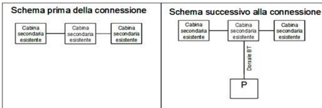
Figura 2 - Inserimento in antenna da cabina MT/BT
